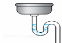
用回水管的“水封” 阻隔臭气
